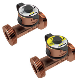
CONTROL-PLUS flow- en temperatuursensor, figuur 138 4G/GBS-versie figuur 138 6G Voor de exacte meting en aanpassing van flows en temperaturen in drinkwatersystemen. Drukverlie- sarme sensorbehuizing; min. stroomsnelheid 0,2 m/s; max. stroomsnelheid 2,5 m/s; temperatuur- meetbereik 0 - 100 °C.
